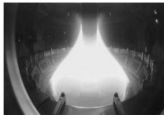
l'énergie de ces neutrons, transférée sous forme de chaleur à un liquide caloporteur qui circule dans les parois du tokamak, qui va permettre de produire de l'électricité. Pour maintenir le plasma -- et donc les réactions de fusion nucléaire --, il faut, en revanche, éviter que celui-ci entre en contact direct avec les parois en question. Il faut donc réussir à le confiner. Grâce à un champ magnétique.
